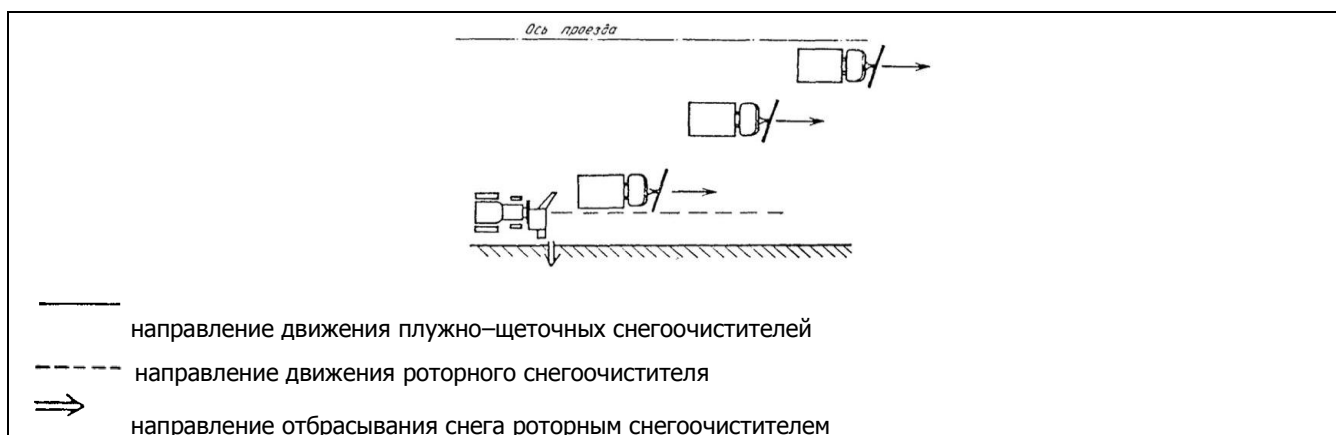
Рисунок 2.6 – Схема расчистки проезжей части улиц колонной плужно-щеточными снегоочистителями и перекидывание снега роторным снегоочистителем
